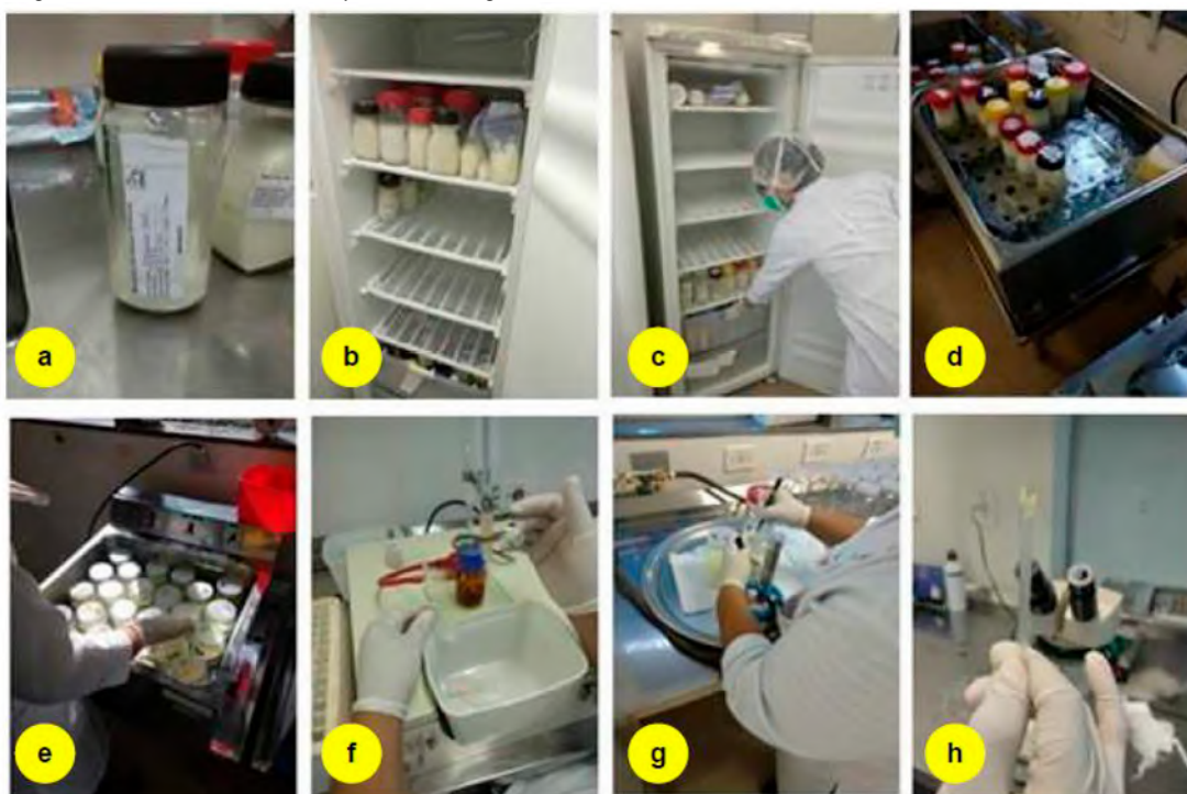
Figura 1: Algumas etapas do processo de pasteurização: (a) Identificação dos frascos de leite doado; (b) Armazenamento/entrada; (c) Armazenamento/saída; (d) Descongelamento; (e) Aquecimento e homogeneização; (f) Análise de acidez; (g) Registro manual; (h) Medição da quantidade de gordura.
